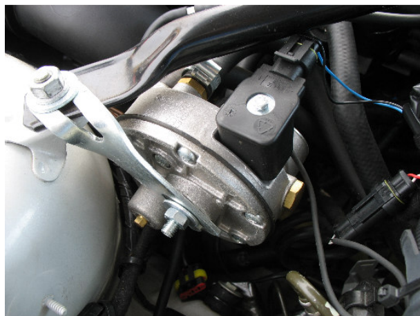
wspornik reduktora, podłączenie elektryczne zaworu odcinającego
